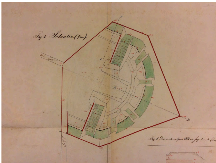
Afb. 29: De plattegrond van ravelijn 6 van 28 april 1873. Er is slechts sprake van twee kleine kazernes annex remisegebouwen en geschutopstellingen in de openlucht. De kazematten zijn geheel uit het plan verdwenen (NA 2.13.01-3608-71G)
