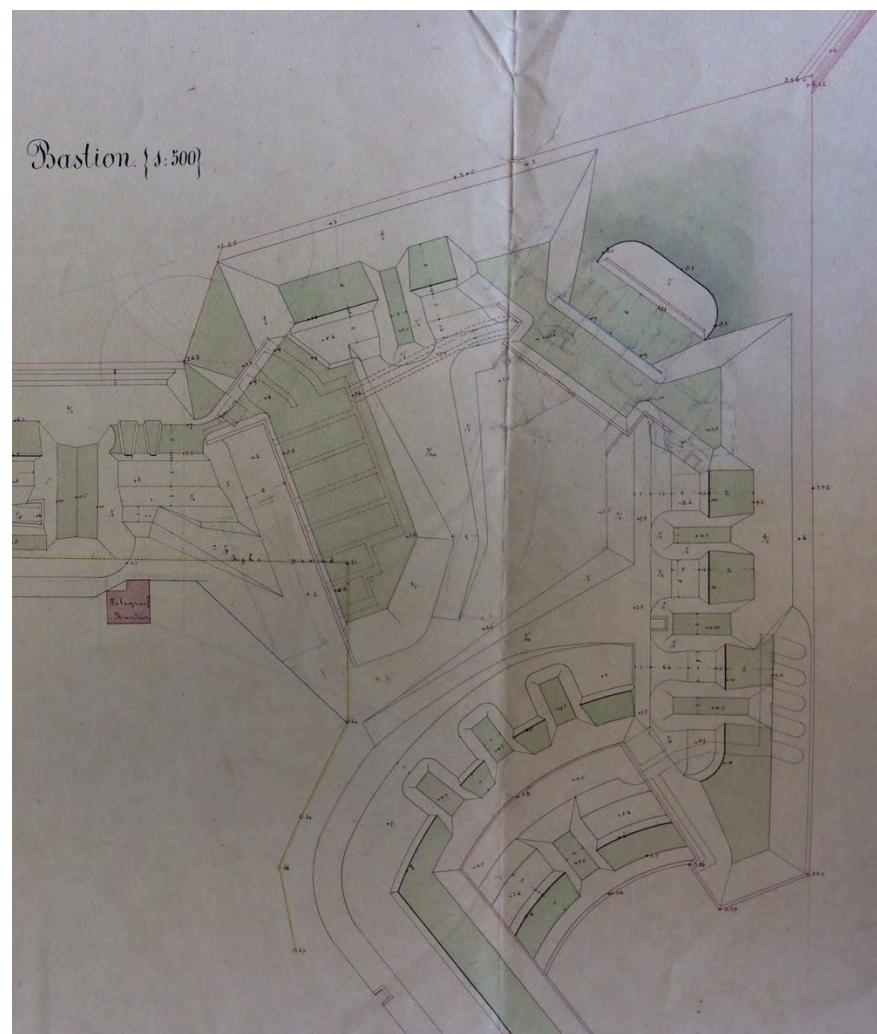
Afb. 25: De plattegrond van bastion Oranje van 13 april 1874. Het heeft in grote lijnen de indeling die het bastion tegenwoordig ook heeft. Gebouw H is in dit ontwerp echter kleiner en voorzien van een verdieping met drie gepantserde geschutstanden (NHA 548, inv. nr. 192)
